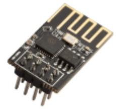
L'**ESP-01** est un circuit imprimé avec pour caractéristique un **microcontrôleur ESP8266EX**, une **mémoire SPI Flash** de 1 MB à 16 MB, une **antenne sur PCB de 3 dBi** et un **connecteur 8 broches**.
