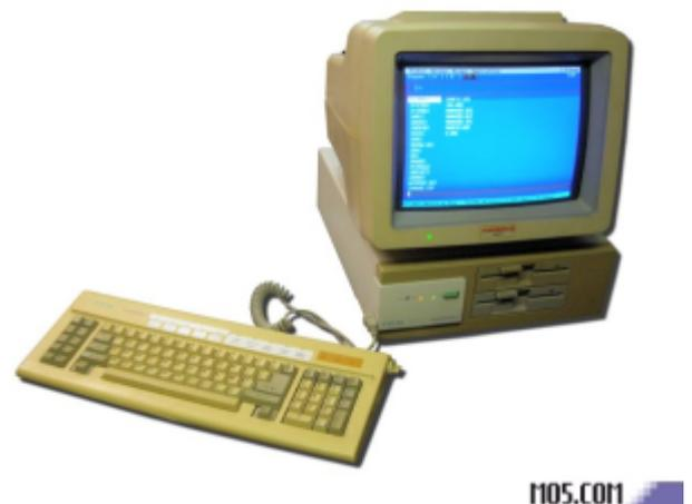
Il était un ordinateur personnel qui a été lancé en 1987. Il était équipé d'un processeur **Intel 8088** qui tournait à des fréquences de 4.77 ou 9.54 MHz. Il était également compatible avec un co-processeur **Intel 8087**, ce qui lui permettait de gérer des calculs plus complexes. Il avait également 512 KB de RAM, qui pouvait être étendu jusqu'à 768 KB sur la carte mère, et 32 KB de ROM.
