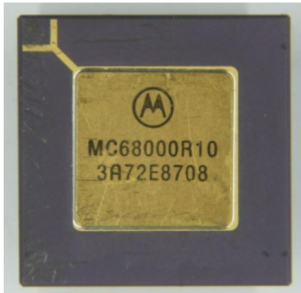
Le **Motorola 68000** est un microprocesseur **16 bits** fabriqué par Motorola. Il a été introduit en 1979 et a été utilisé dans de nombreux ordinateurs personnels et professionnels dans les années 1980 et 1990. Il possède une architecture de type Von Neumann, avec un bus de données de 16 bits et un bus d'adresses de 24 bits, permettant l'accès à **16 Mo de mémoire**. Il est capable d'exécuter des instructions à une vitesse de **8 MHz**.
